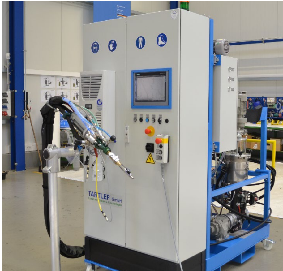
Abbildung 3.1.2.17: Für die RTM-Versuche, am Fraunhofer IGCV eingesetzte NODOPUR VS-2K Tartler Injektionsanlage.
