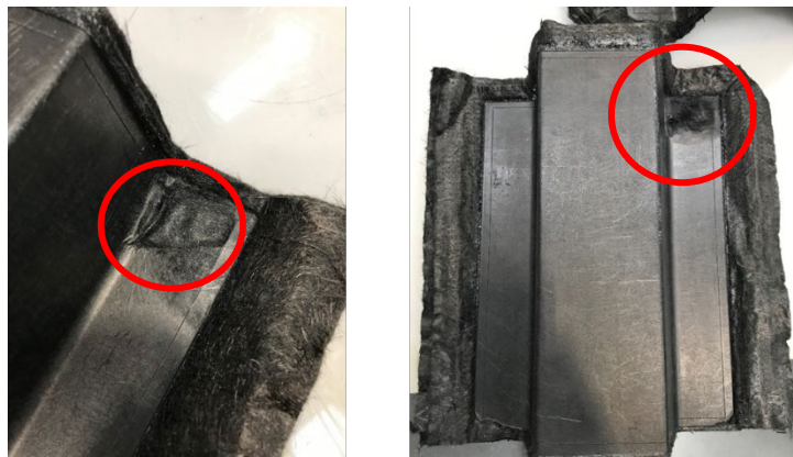
Abbildung 3.1.1.7: D-9.2 Fehlstelle (links), D-11.3 Fehlstelle (rechts).
