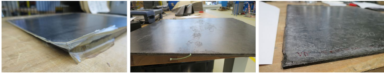
Abbildung 3.2.1.1: Unterschiedliche Fehlerbilder bei der Herstellung von Organovliesstoffen. Links: Austretende Matrix Mitte: Trockene Stellen in der Mitte der Platte Rechts: Trockene Stellen am Rand der Platte
