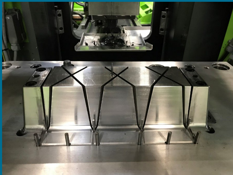
Abbildung 3.2.5.40: Darstellung des Hutprofil-Spritzgusswerkzeuges der SGL Carbon.
