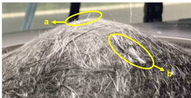
Abbildung 3.2.2.19: Vom Vliesstoff abgehobene Fasern (a.) und Rovings (b. [Guo20]).
