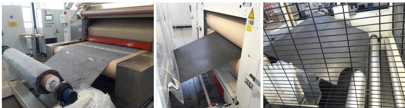
Abbildung 3.2.1.11: Kontinuierliche Herstellung von Organoblechen an der KFK-XL bei der Firma Maschinenfabrik Herbert Meyer GmbH.
