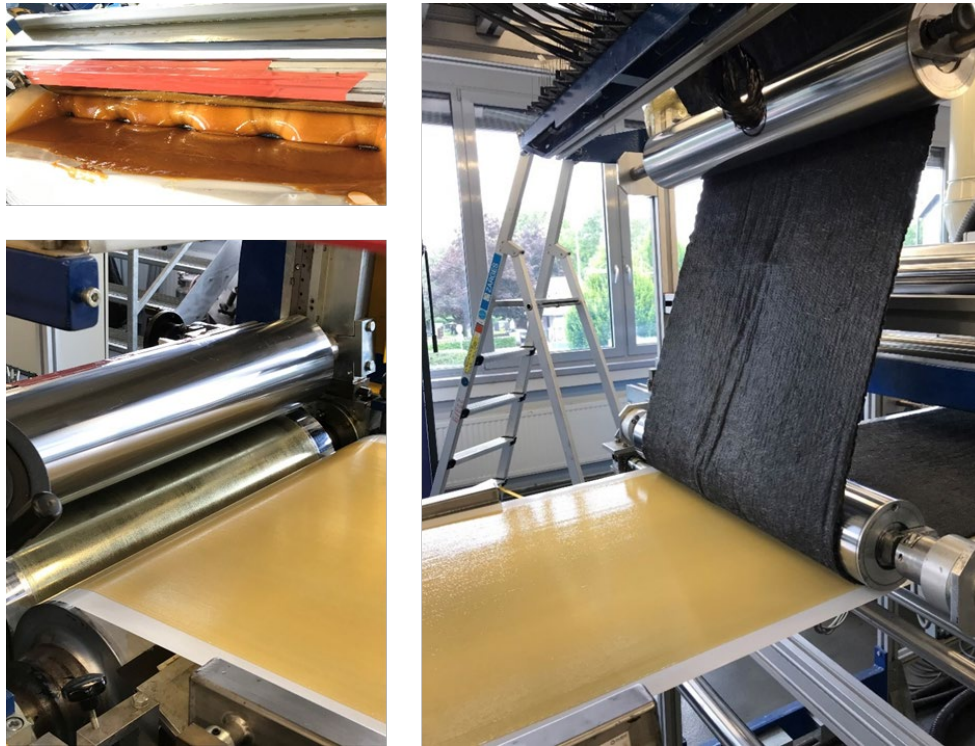
Abbildung 3.1.1.15: links, oben: Harzzuführung, links, unten: Dosierwalze und Harzfilm, rechts: Trockenes Vlies wird auf Harzfilm aufgelegt.
