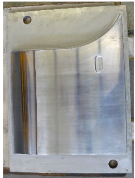
Abbildung 6.3.1.2: Links: AHB-Werkzeug Unterseite. Rechts: AHB-Werkzeug-Oberseite. Eine Herausforderung stellen die benötigten Zuschnitte für die Nasspressversuche dar. Die Zuschnitte werden auf Basis der CAD-Abwicklung (Abbildung 6.3.1.1) angefertigt und von Versuch zu Versuch angepasst.
