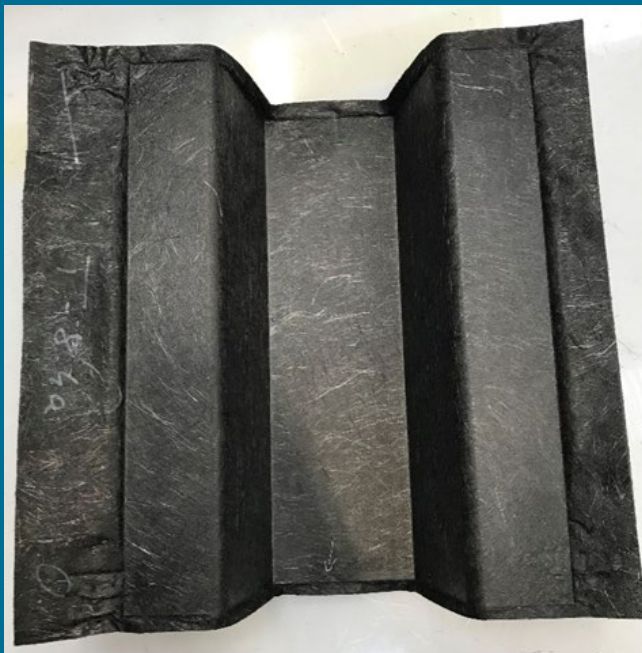
Abbildung 3.2.4.38: Links: T-8.4a umgeformtes Organoblech von unten. Rechts: T-8.4a umgeformtes Organoblech von oben.
