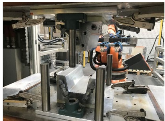
Abbildung 3.1.1.6: Hutprofil und Hutprofilwerkzeug (rechts) für die CAx-Integration und Validierung bei EDAG.
