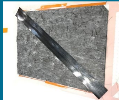
Abbildung 3.2.3.30: Links: Kreuzförmige Verstärkung der Organobleche. Rechts: Vlieslage mit aufgeschweißtem Tape-Streifen.
