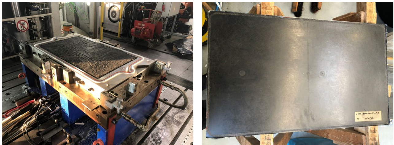
Abbildung 3.1.2.19: RTM-Werkzeug mit eingelegten Vliesstoff (links) und vollständig infiltrierte Platte (rechts) als Ergebnis der RTM-Versuchen am Fraunhofer ICT.
