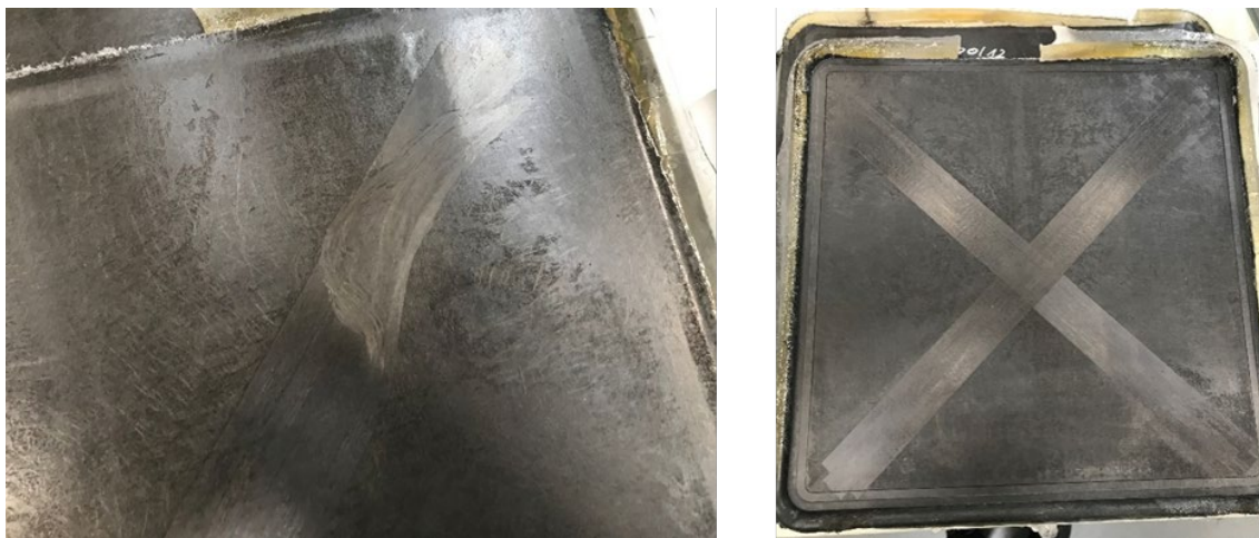
Abbildung 3.1.3.24: Links: Verschwemmung der Verstärkung durch den Harzfluss. Rechts: Lokal verstärkte Nasspressplatte ohne Verschwemmungen.
