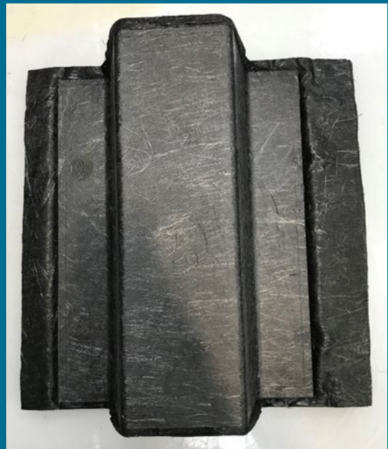
Abbildung 3.2.4.38: Links: T-8.4a umgeformtes Organoblech von unten. Rechts: T-8.4a umgeformtes Organoblech von oben.
