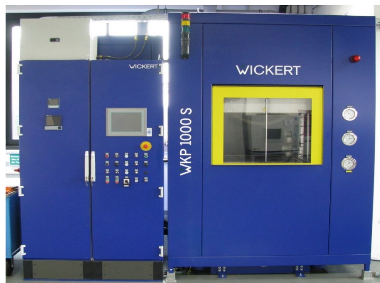
Abbildung 3.2.1.8: Heiß-Vakuum-Pressen "WKP 1000S" von WICKERT.
