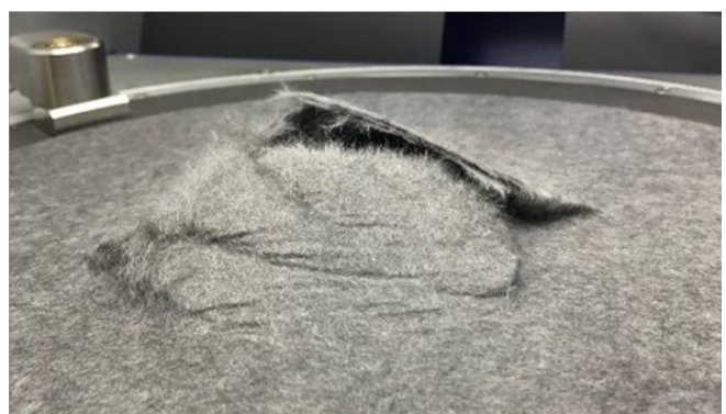
Abbildung 3.2.23 : Umgeformte Vliesstoffe und typisches Fehlerbild von schlecht drapierbaren Materialien. #8 (oben links), #2 (oben rechts), # 11(unten rechts), #NV1.2 (unten rechts).
