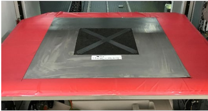
Abbildung 3.1.3.23: Links: Blech zur Fixierung des rCF-Vlieses auf dem Vakuumtisch. Rechts: lokale Verstärkung der Vliesstoffe für die Hutprofil Geometrie.
