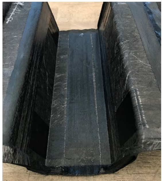
Abbildung 3.2.4.37: Links: Nachträglich lokal verstärktes Organoblech. Rechts: Nachträglich verstärktes umgeformtes Organoblech.
