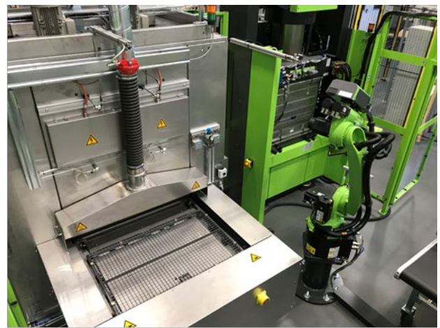
Abbildung 3.2.4.39: Links: Spritzgussanlage „Engel – Insert 200“. Rechts: Umluftofen und Roboter bei der SGL.
