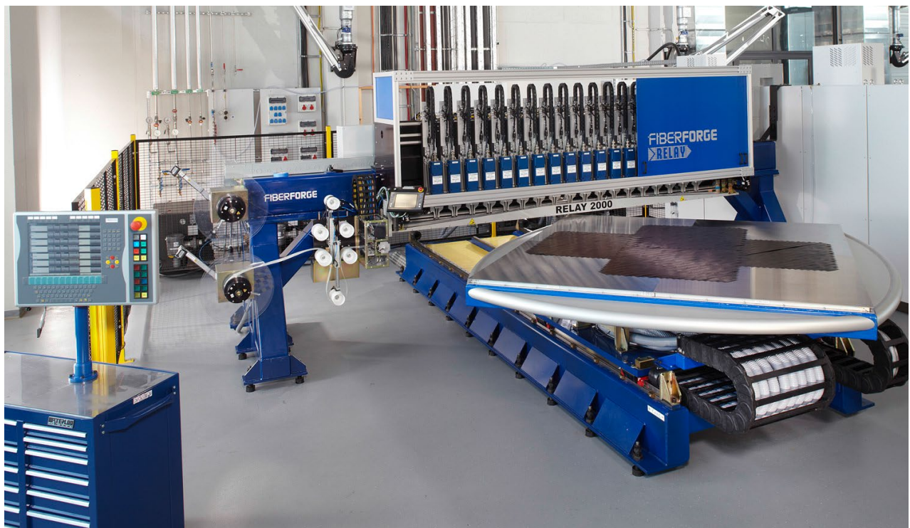
Abbildung 3.2.3.28: FiberForge Relay 2000 Anlage des Fraunhofer IGCV beim SGL Fiber Placement Center.
