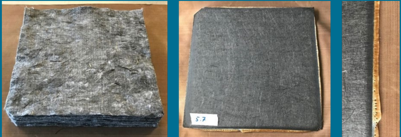
Abbildung 3.2.1.10: Links: Unkonsolidierter Stack. Mitte: Konsolidiertes Organoblech. Rechts: Polymerrand.
