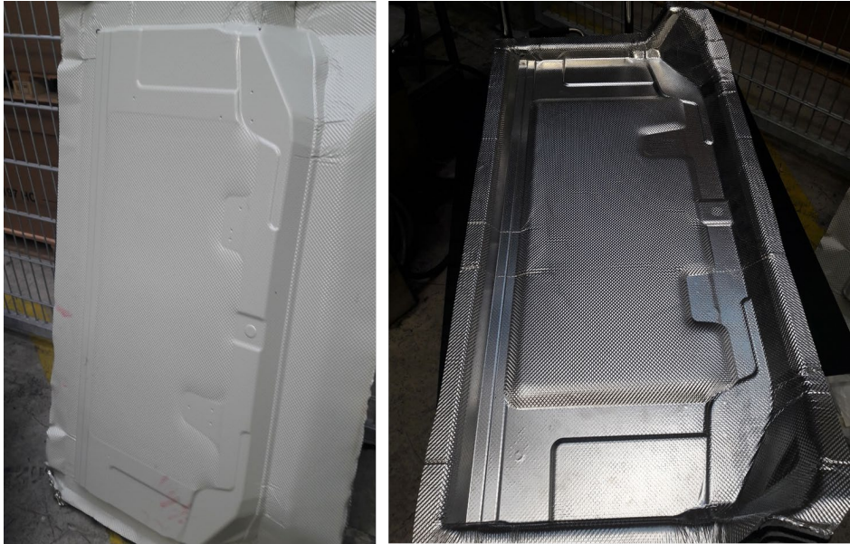
Abbildung 6.3.3.1: Unterbodenstruktur von Röchling Automotive aus recycelten Carbonfasern überzogen mit Aluminiumfolie.
