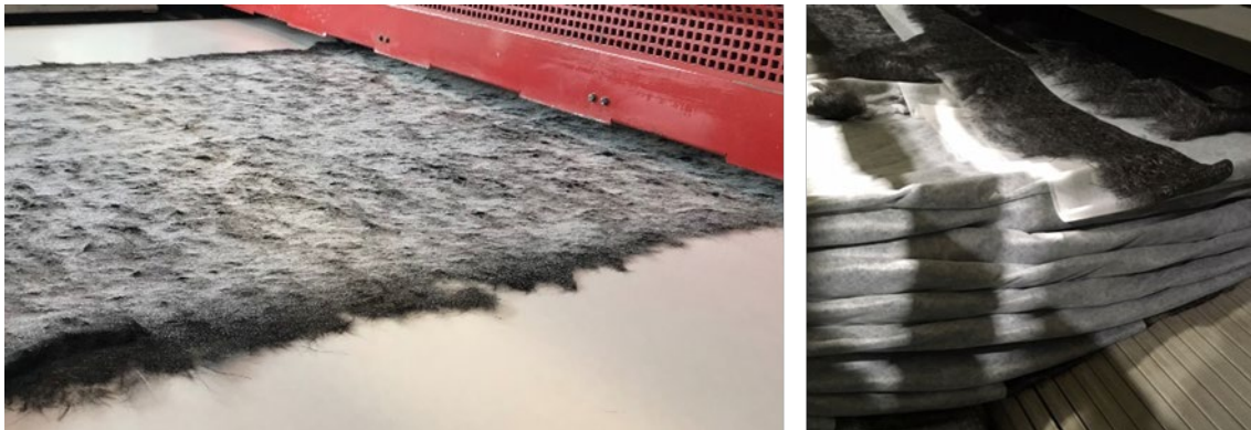
Abbildung 2.2.2.12: Pulverbestreutes rCF-Flor (links) und Vliesstacking (rechts) mit PA6 Material.
