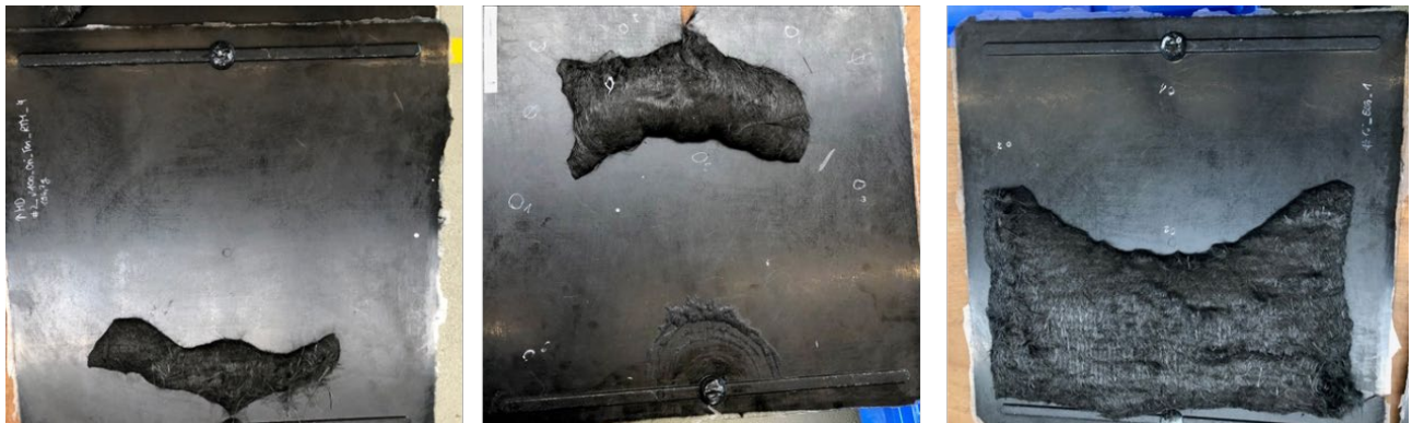
Abbildung 3.1.2.18: Unvollständig infiltrierte Platten bei den RTM-Versuchen am Fraunhofer IGCV.
