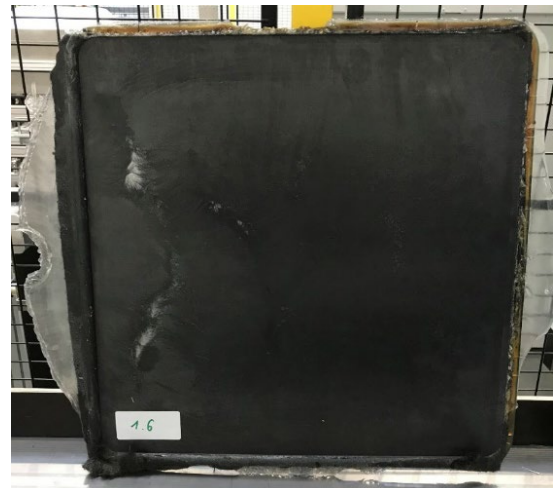
Abbildung 3.1.1.5: 4 mm Nasspressplatte mit Reinharzbereichen.
