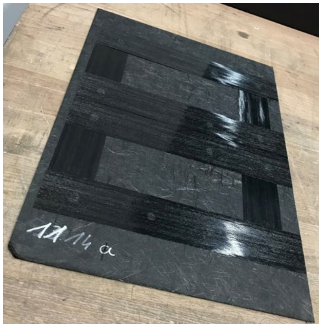
Abbildung 3.2.4.37: Links: Nachträglich lokal verstärktes Organoblech. Rechts: Nachträglich verstärktes umgeformtes Organoblech.
