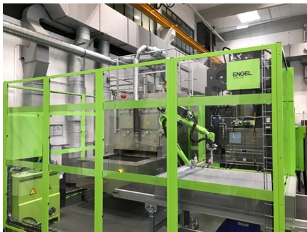
Abbildung 3.2.4.39: Links: Spritzgussanlage „Engel – Insert 200“. Rechts: Umluftofen und Roboter bei der SGL.
