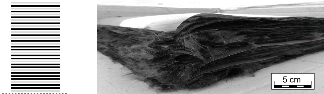
Abbildung 2.2.2.13: Aufbau des rCF-Flor/Folien-Stacks bestehend aus 36 rCF-Flor und 26 Folienlagen.
