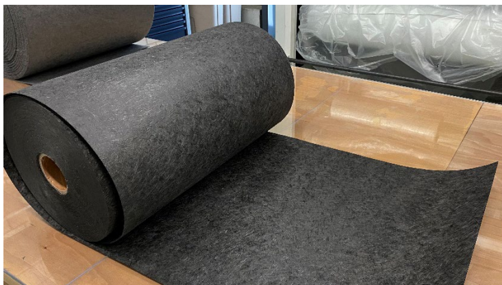
Abbildung 2.3.1: Kommerzielle Nassvliese. Links: 30% PA6/rCF Nassvlies der Firma AWA Paper, rechts: 100% rCF Nassvlies der Firma Marubeni.
