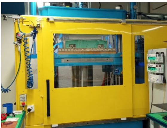
Abbildung 3.1.1.8: Presse zum Nasspressen bei Huntsman nach dem DFCM-Verfahren (Bild links) und fertige Platte aus 5 Lagen Tenowo Vliesstoff (Bild rechts).
