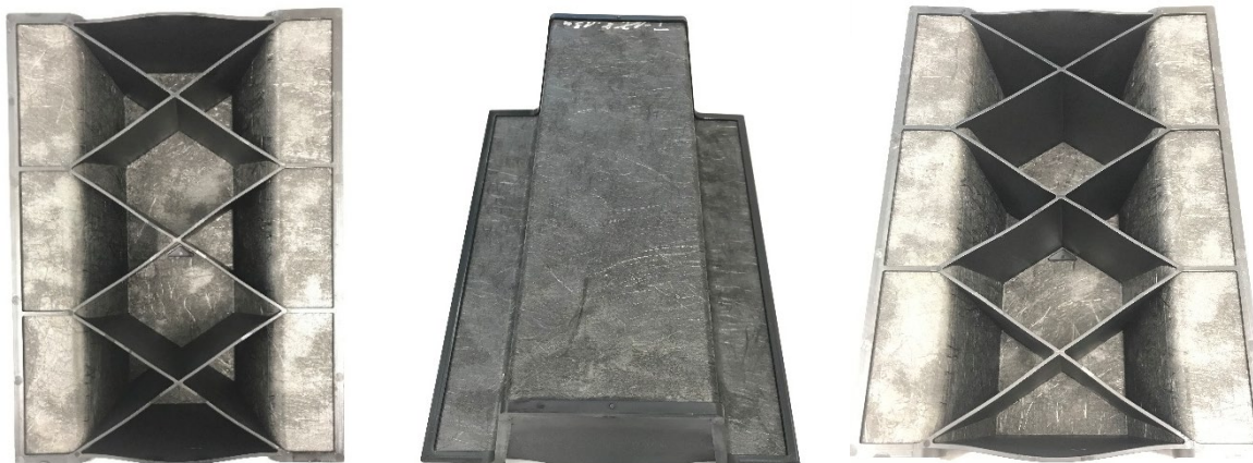
Abbildung 3.2.5.42: T-12a: Vollständige Füllung aller Schmelze-Kavitäten; Ausbeulen der äußeren Wände.
